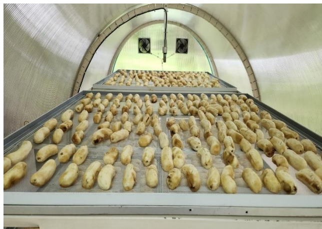
รูปภาพที่ 4.8 ลักษณะการวางกล้วยน้ำว้าในถาดตากของโรงอบตากพลังงานแสงอาทิตย์ที่ประยุกต์ใช้ระบบ IoT
