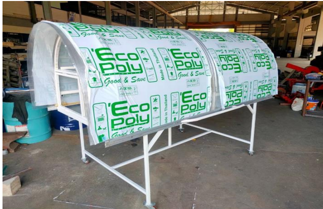
รูปภาพที่ 3.7 ลักษณะชุดโครงสร้างด้านบนที่ทำการหุ้มโพลีคาร์บอเนตแล้วเสร็จ
