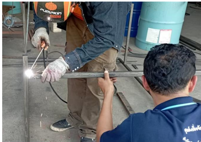
รูปภาพที่ 3.3 การสร้างประกอบชุดโครงสร้างด้านล่างบริเวณส่วนขาและส่วนเสริมความแข็งแรง
